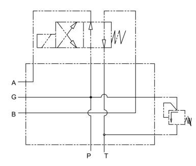
P : Pump inlet port T : Tank port A : Outlet port B : Outlet port G : Gauge port
